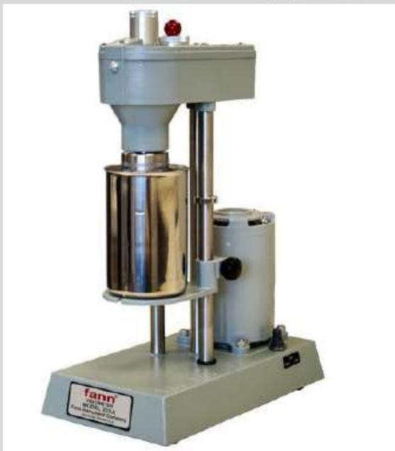
**Figura 4.5. Viscosímetro de flujo Couette, Fann 35.**
