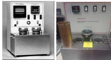
Figura 2. Consistómetro Atmosférico 165
