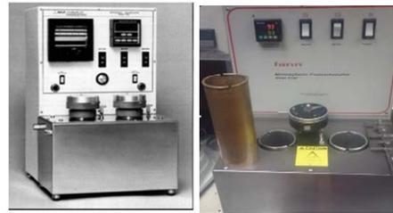
Figura 2. Consistómetro Atmosférico 165 AT
