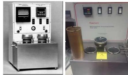
Figura 2. Consistómetro Atmosférico 165 AT
