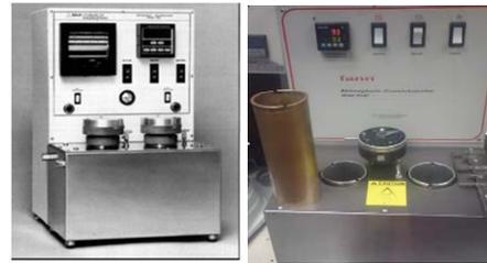
Figura 2. Consistómetro Atmosférico 165
