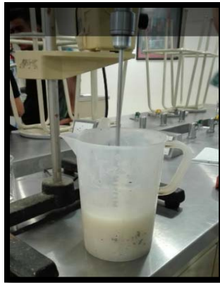
Figura 1. Acondicionamiento del Fluido Fracturante en reposo.
